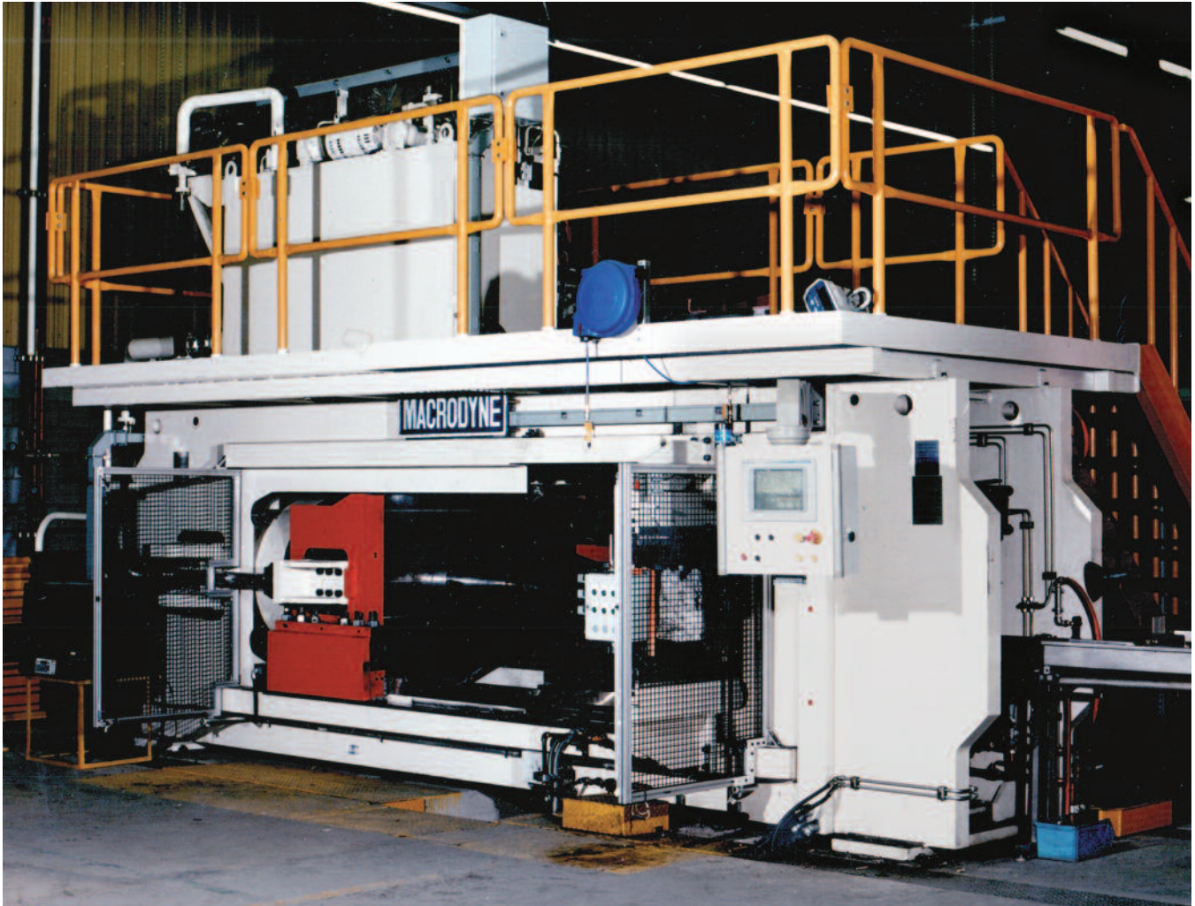
900 ton horizontal extrusion press line
