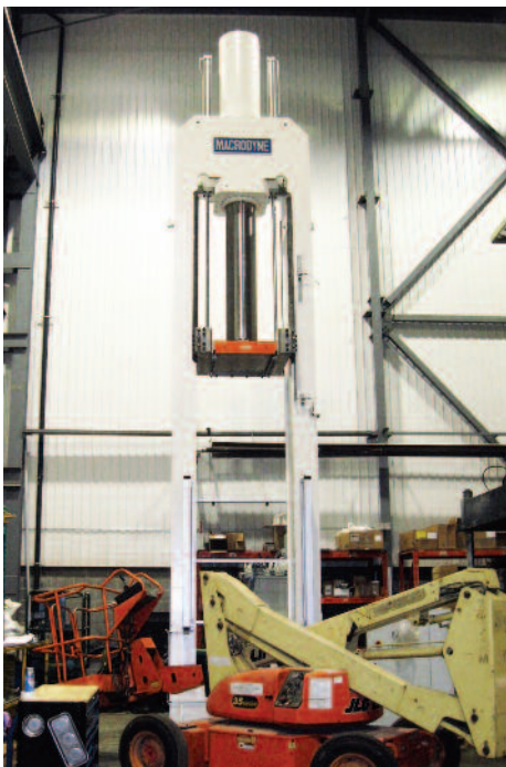
465 ton compaction press for teflon billet production
