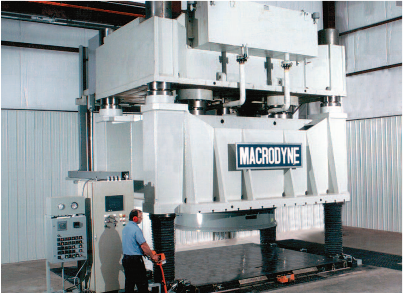
3000 ton sheet hydroforming press
