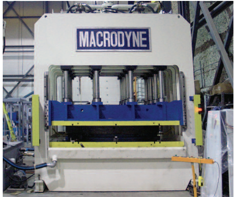
1500 ton sheet hydroforming press
