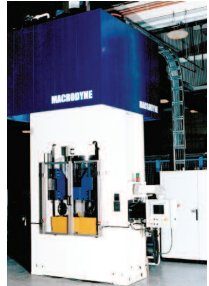
750 ton hydroforming R&D press
