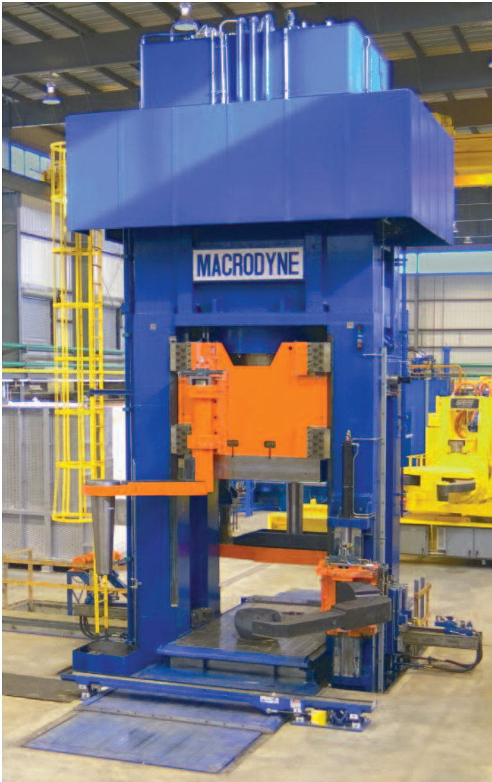
5500 ton ring blank forging press
