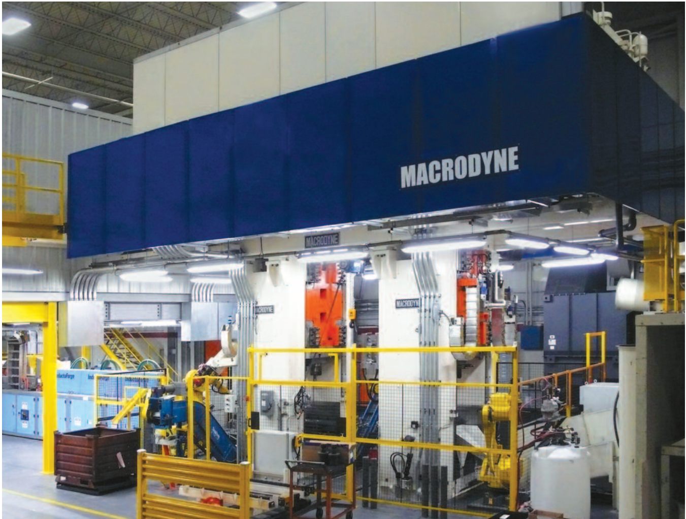
1100 ton forging press line
