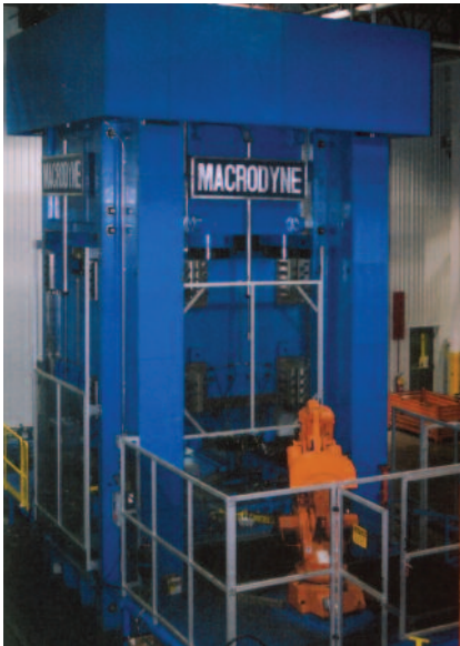
2500 ton tube hydroforming press
