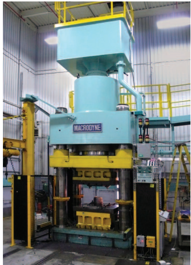
2000 ton open die forging press
